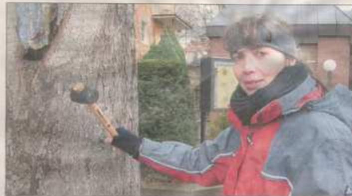
Am Klang der Hammerschläge erkennt Claudia Amelung, ob der Baum Hohlstellen aufweist und somit vom Pilz befallen sein könnte.
